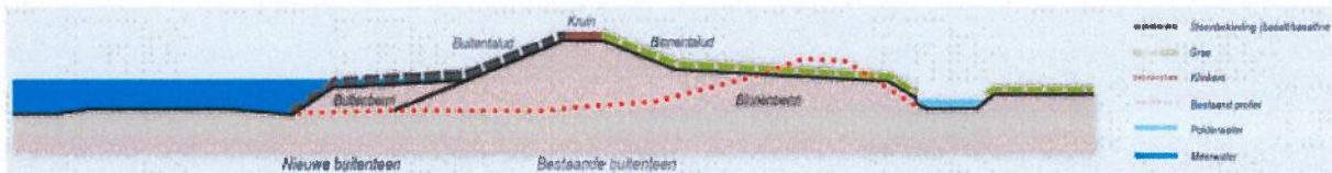
Figuur 2.5 Dwarsprofiel Zuidkade, compact profiel
